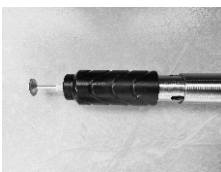
1、装一体钉 将一体钉对准紧固器发射管并装入。
