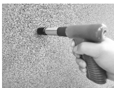
3、快速紧固 将紧固器头部垂直对准基体，握住握把或加长杆快速前（上）推紧固器，完成紧固。
