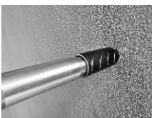
3、快速紧固 将紧固器头部垂直对准基体，握住握把或加长杆快速前（上）推紧固器，完成紧固。
