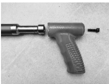
4、拆卸握把 根据使用情况选择握把或加长杆。将握把拆卸后，将紧固器与加长杆连接。
